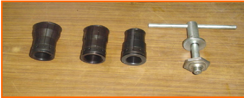
الشكل (1- 22) يبين عدة إخراج رومان البلي المركب بالتجاويف المسدودة
