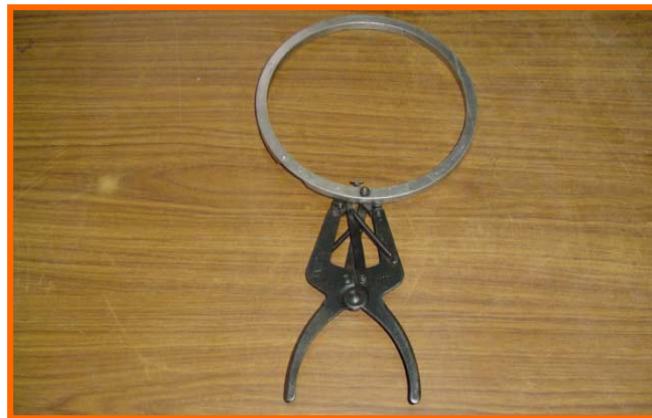
الشكل (1- 20) يبين عدة تركيب وفك الشنابر من المكبس
